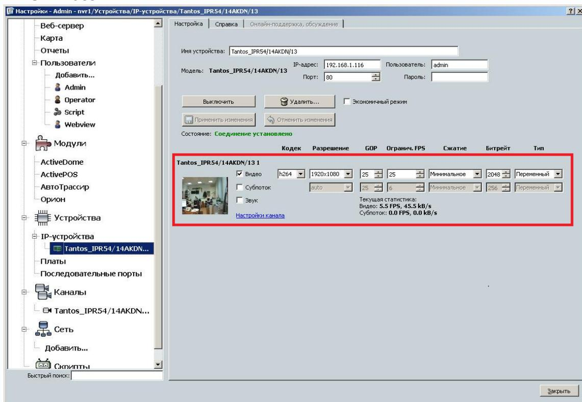
ПО «Trassir» покажет параметры подключения к камере. Нужно установить требуемый битрейт, количество кадров в секунду, при необходимости включить второй видеопоток для отображения.
